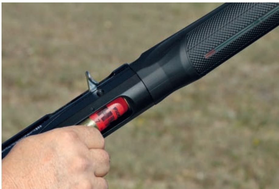
Inserendo una cartuccia nel serbatoio, il tappo in alluminio anodizzato di colore rosso viene spinto verso il primo dei cinque fori del serbatoio e così avverte della presenza della cartuccia all'interno.
